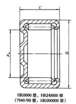
穿孔型冲压外圈滚针轴承
