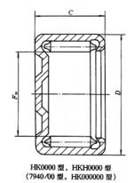
穿孔型冲压外圈滚针轴承
